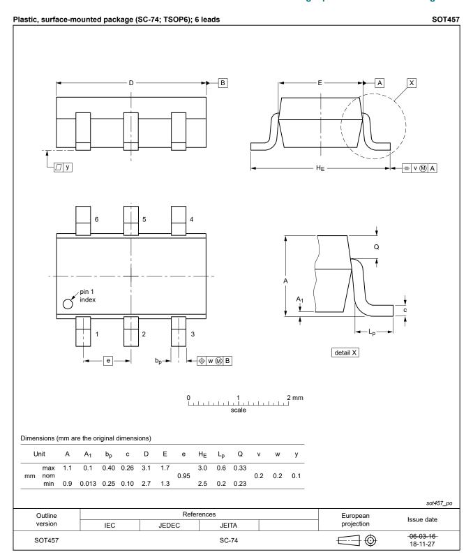
Fig. 21. Package outline SOT457 (SC-74; TSOP6)
