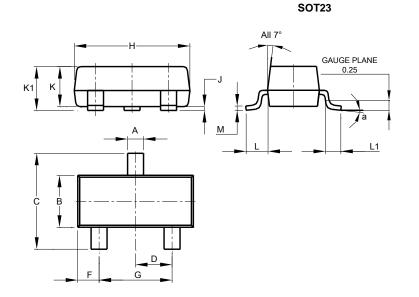
SOT23 Dim Min Max Тур 0.37 0.51 0.40 Α В 1.20 1.40 1.30 С 2.30 2.50 2.40 1.03 D 0.89 0.915 F 0.45 0.60 0.535 G 1.78 2.05 1.83 Н 2.80 3.00 2.90 J 0.05 0.013 0.10 Κ 0.890 1.00 0.975 K1 0.903 1.10 1.025 L 0.45 0.61 0.55 L1 0.25 0.55 0.40 М 0.085 0.150 0.110 а 0° 8° All Dimensions in mm
