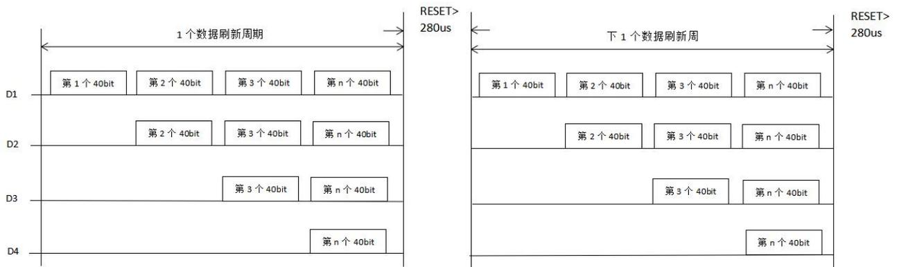
注：其中 D1 为 MCU 端发送的数据，D2、D3、D4 为级联电路自动整形转发的数据。
