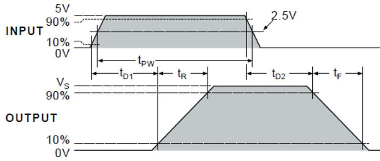
图 9-1 输入输出(同相)波形图
