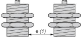
$e(1) \geq 10$  毫米/0.39 英寸
