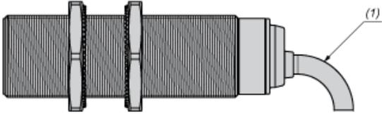
(1) 弯曲电缆：外部电缆直径的 4 倍
