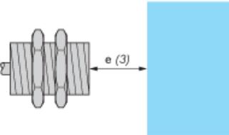
$e(3) \geq 15$  毫米/0.60 英寸
