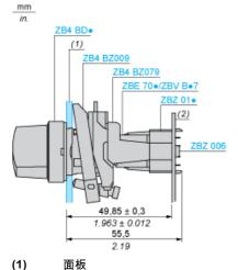
(1) 面板 (2) 印刷电路板
