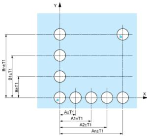
A: 30毫米(最小值)/1.18英寸(最小值) B: 40毫米(最小值)/1.57英寸(最小值)
