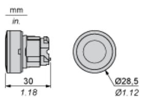
用于按钮、开关和指示灯的面板开口 ( 成孔 , 供安装之用 )
