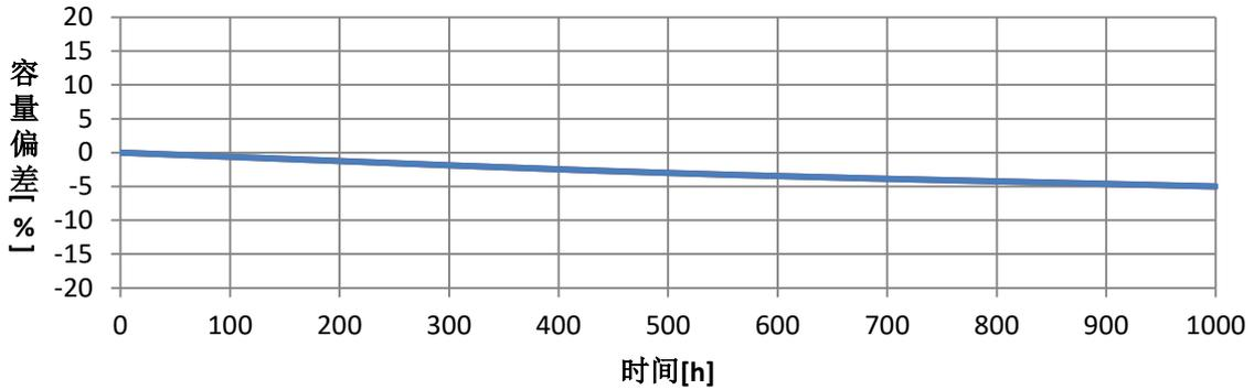
在测试环境（温度85℃，相对湿度85%，240VAC）下，电容器在连续稳定运行500小时后， $c \leq 3\%$ ；连续稳定运行1000小时后， $c \leq 10\%$ ， $tg\delta \leq 3 \times 10^{-3}$ 。
