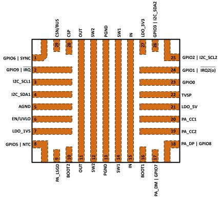
Figure 6-1. RQL Package 29-Pin (VQFN) Top View
