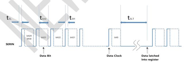
配置数据通过串行输入"SERIN"设置。外部微控制器 在 SERIN 引脚上生成一个上升沿,随后电平表示配置数据的比特值,由 SERIN 引脚 设置为 0 或 1,数据位的时间大于 72μS. 当设备已经接收到超过 25bits 数据时,超过 580μS 以上传送被中断,接收到的 LSB 被锁存到所述配置寄存器。
