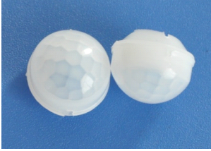
型号: 018090 尺寸: \varnothing 17.9 * 13.9 焦距: 9mm 感应角度: 120° 感应距离: 8m
