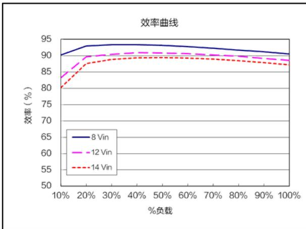
效率曲线 ( $V_{nom}=12.0V$ ,  $V_{out}=3.3V$ )
