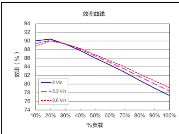
效率曲线 ( $V_{nom}=3.3\text{V}$ ,  $V_{out}=0.6\text{V}$ )
