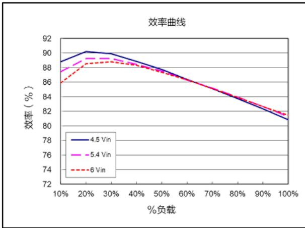
效率曲线 ( $V_{nom}=5.4V$ ,  $V_{out}=0.7V$ )
