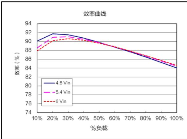
效率曲线 ( $V_{nom}=5.4V$ ,  $V_{out}=1.0V$ )
