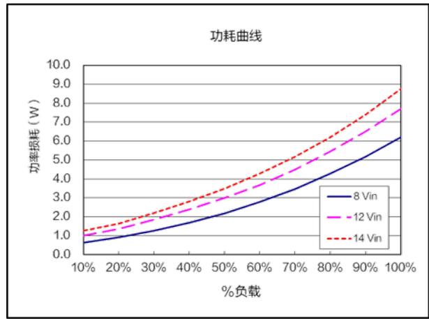
功耗曲线 ( $V_{nom}=12.0V$ ,  $V_{out}=2.5V$ )
