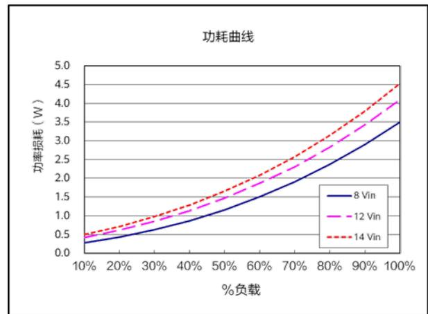
功耗曲线 ( $V_{nom}=12.0V$ ,  $V_{out}=0.6V$ )
