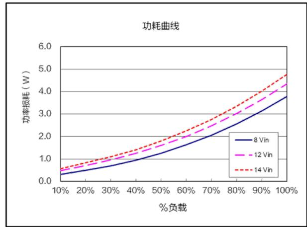
功耗曲线 ( $V_{nom}=12.0V$ ,  $V_{out}=0.8V$ )
