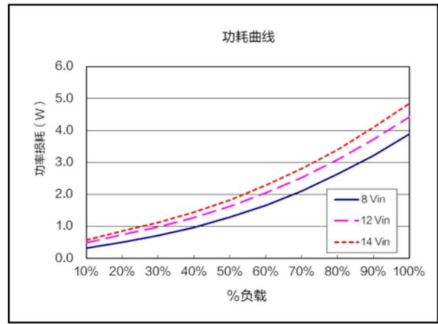
功耗曲线 ( $V_{nom}=12.0V$ ,  $V_{out}=0.9V$ )
