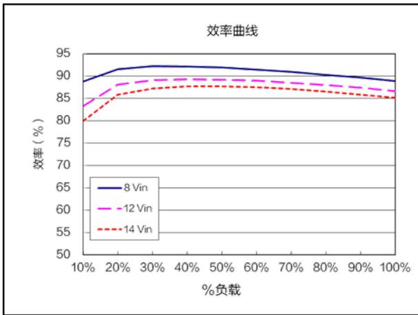
效率曲线 ( $V_{nom}=12.0V$ ,  $V_{out}=2.5V$ )
