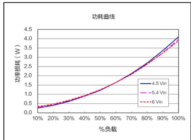
功耗曲线 ( $V_{nom}=5.4V$ ,  $V_{out}=1.2V$ )
