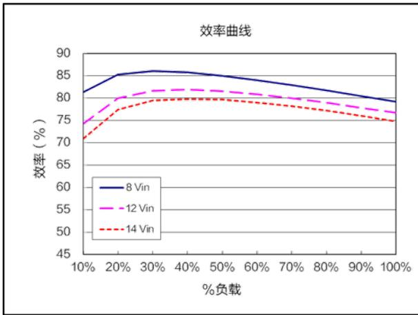
效率曲线 ( $V_{nom}=12.0V$ ,  $V_{out}=0.7V$ )
