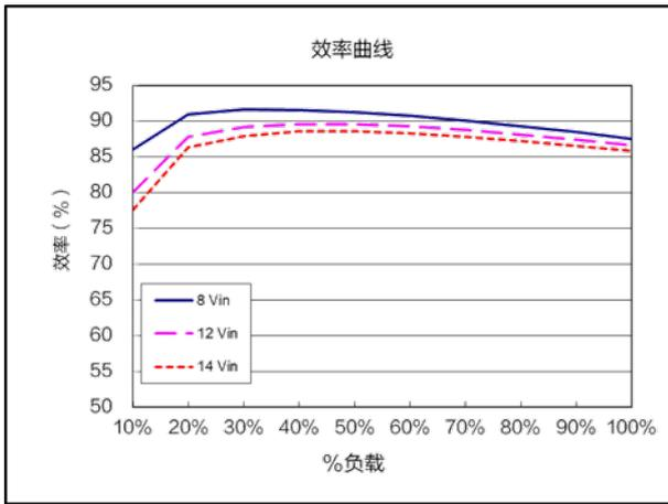
效率曲线 ( $V_{nom}=12.0V$ ,  $V_{out}=1.8V$ )
