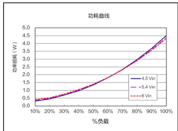
功耗曲线 ( $V_{nom}=5.4V$ ,  $V_{out}=1.5V$ )
