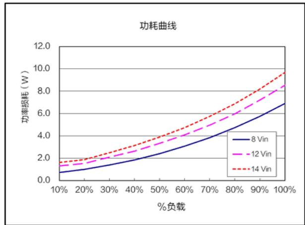
功耗曲线 ( $V_{nom}=12.0V$ ,  $V_{out}=3.3V$ )
