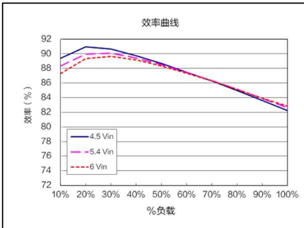
效率曲线 ( $V_{nom}=5.4V$ ,  $V_{out}=0.8V$ )
