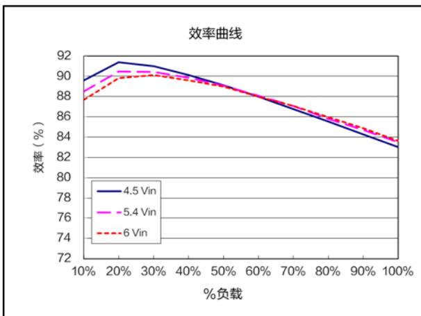
效率曲线 ( $V_{nom}=5.4V$ ,  $V_{out}=0.9V$ )
