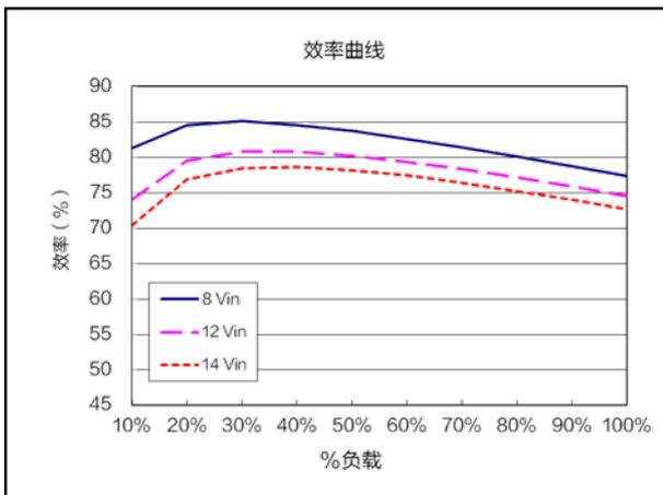
效率曲线 ( $V_{nom}=12.0V$ ,  $V_{out}=0.6V$ )
