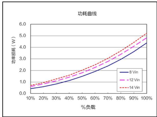
功耗曲线 ( $V_{nom}=12.0V$ ,  $V_{out}=1.2V$ )
