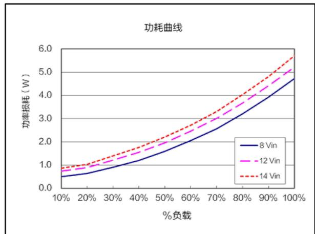
功耗曲线 ( $V_{nom}=12.0V$ ,  $V_{out}=1.5V$ )
