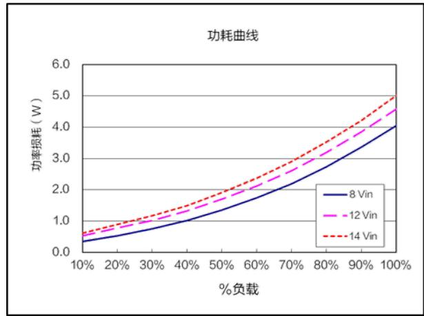
功耗曲线 ( $V_{nom}=12.0V$ ,  $V_{out}=1.0V$ )
