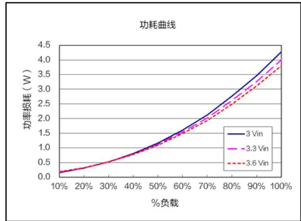
效率曲线 ( $V_{nom}=3.3V$ ,  $V_{out}=1.0V$ )
