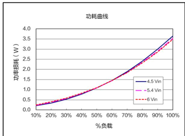
功耗曲线 ( $V_{nom}=5.4V$ ,  $V_{out}=0.9V$ )
