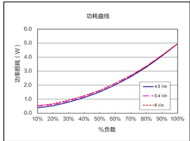
功耗曲线 ( $V_{nom}=5.4V$ ,  $V_{out}=2.1V$ )
