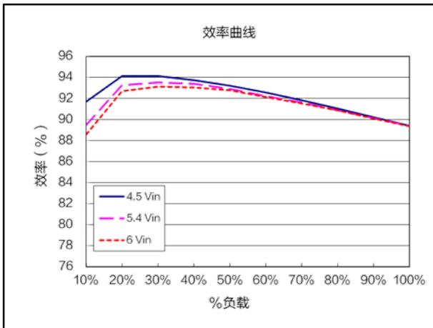
效率曲线 ( $V_{nom}=5.4V$ ,  $V_{out}=2.1V$ )
