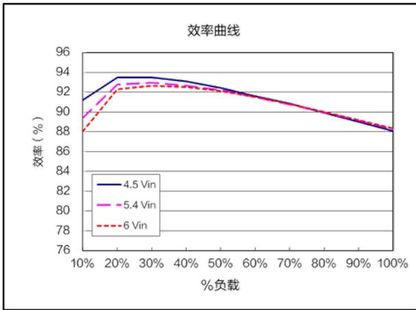
效率曲线 ( $V_{nom}=5.4V$ ,  $V_{out}=1.8V$ )
