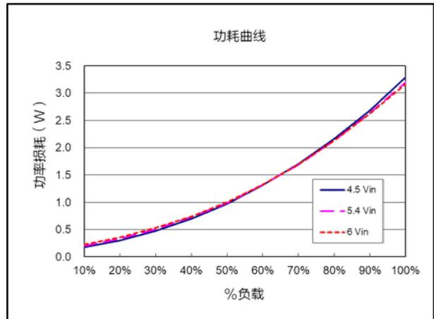
功耗曲线 ( $V_{nom}=5.4V$ ,  $V_{out}=0.7V$ )
