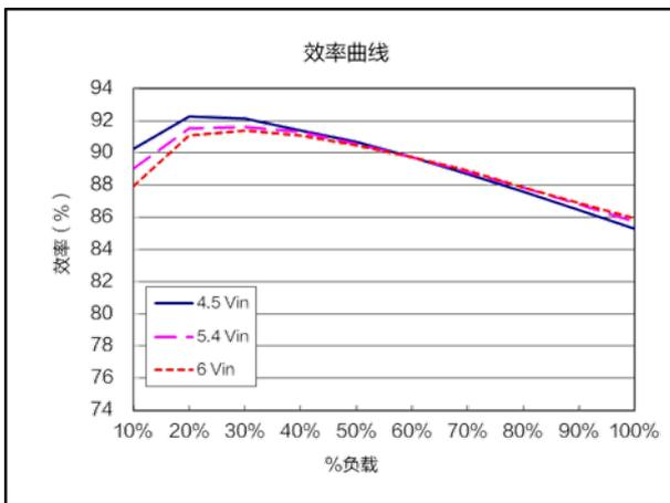
效率曲线 ( $V_{nom}=5.4V$ ,  $V_{out}=1.2V$ )
