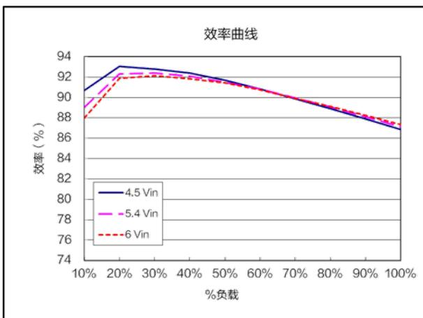
效率曲线 ( $V_{nom}=5.4V$ ,  $V_{out}=1.5V$ )
