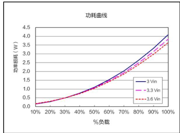
效率曲线 ( $V_{nom}=3.3V$ ,  $V_{out}=0.9V$ )
