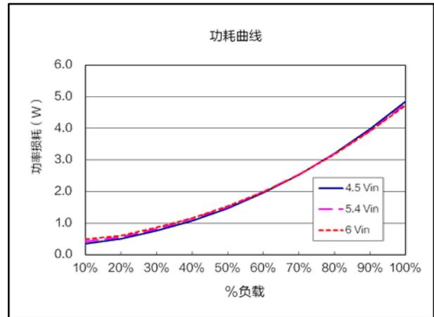
功耗曲线 ( $V_{nom}=5.4V$ ,  $V_{out}=1.8V$ )
