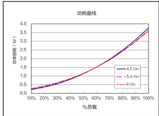
功耗曲线 ( $V_{nom}=5.4V$ ,  $V_{out}=1.0V$ )
