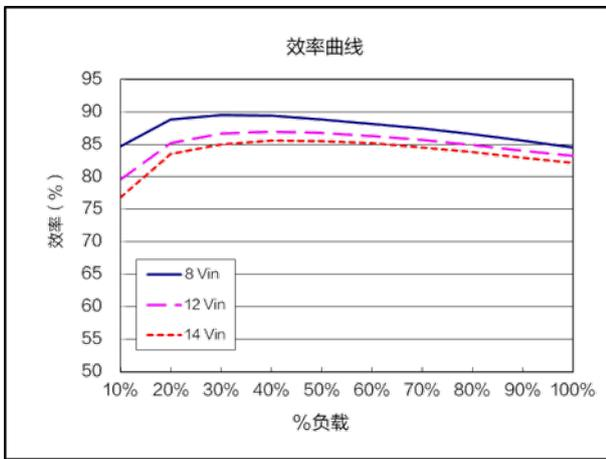
效率曲线 ( $V_{nom}=12.0V$ ,  $V_{out}=1.2V$ )
