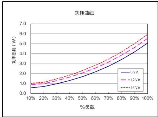
功耗曲线 ( $V_{nom}=12.0V$ ,  $V_{out}=1.8V$ )
