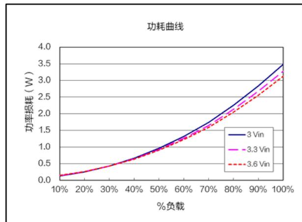
功耗曲线 ( $V_{nom}=3.3\text{V}$ ,  $V_{out}=0.6\text{V}$ )
