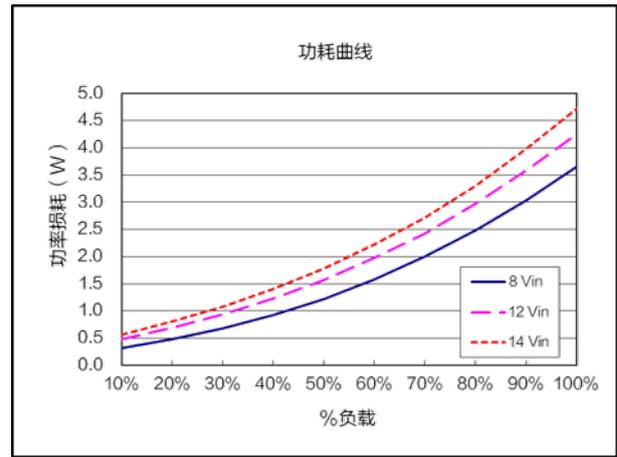
功耗曲线 ( $V_{nom}=12.0V$ ,  $V_{out}=0.7V$ )
