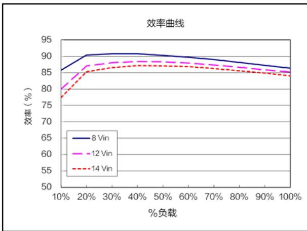
效率曲线 ( $V_{nom}=12.0V$ ,  $V_{out}=1.5V$ )
