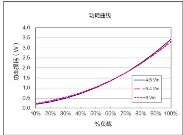
功耗曲线 ( $V_{nom}=5.4V$ ,  $V_{out}=0.8V$ )
