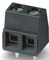
固定式连接器，额定电流: 13.5 A，额定电压(III/2): 320 V，额定横截面: 1.5 mm<sup>2</sup>，电位数: 2，行数: 1，每行位数: 2，产品系列: MKDSN 1,5/..-HT，针距: 5.08 mm，接线方式: 带压片的螺钉连接，螺钉头规格: L 开槽，安装: THR 焊接，导线/PCB连接方向: 0°，颜色: 黑色，针脚排列: 直线排列，焊针[P]: 3.5 mm，每个电势的焊针数量: 1，包装类型: 纸箱包装。该产品可与SMD组件一起放置在回流炉中进行焊接。
