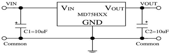
2.高输出电流正电压稳压电路
