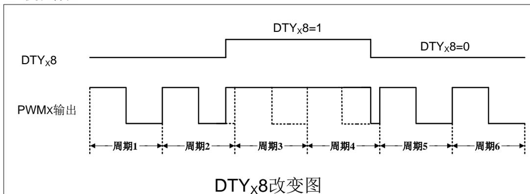
当 PWMx 输出波形时, 若 DTYx8(PWMCR.1/ PWMCR.3)改变, PWMx 波形会立即改变。如上图所示, 在周期 2 中使 DTYx8 置 1, PWMx 会立即响应, 固定输出高; 在周期 4 某处 DTYx8 清 0, PWMx 立即响应, 取消固定输出。
