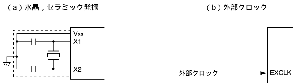
図6 - 12 X1発振回路の外付け回路例
