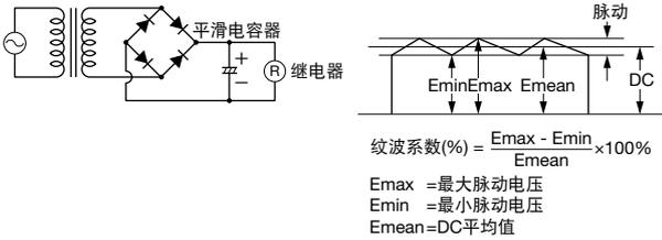
3. 继电器与 AC 负载同步启动：若继电器与 AC 电源电压负载同步启动，会缩短继电器的使用寿命。在此种情况下，请考虑电路的稳定性选择继电器。或者使继电器的断相相位为随机，或在零相位附近断相。
