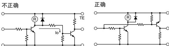
5. 晶体管驱动电路的浪涌抑制在继电器线圈的电流关闭时，产生高压脉冲，会导致晶体管性能劣化，甚至破碎。请务必连接二极管以抑制反电动势。但，此时线圈的释放时间会稍微被延长。需缩短释放时间时，在集电极和晶体管发射极间连接一个齐纳电压稍高于电源电压的齐纳二极管。
