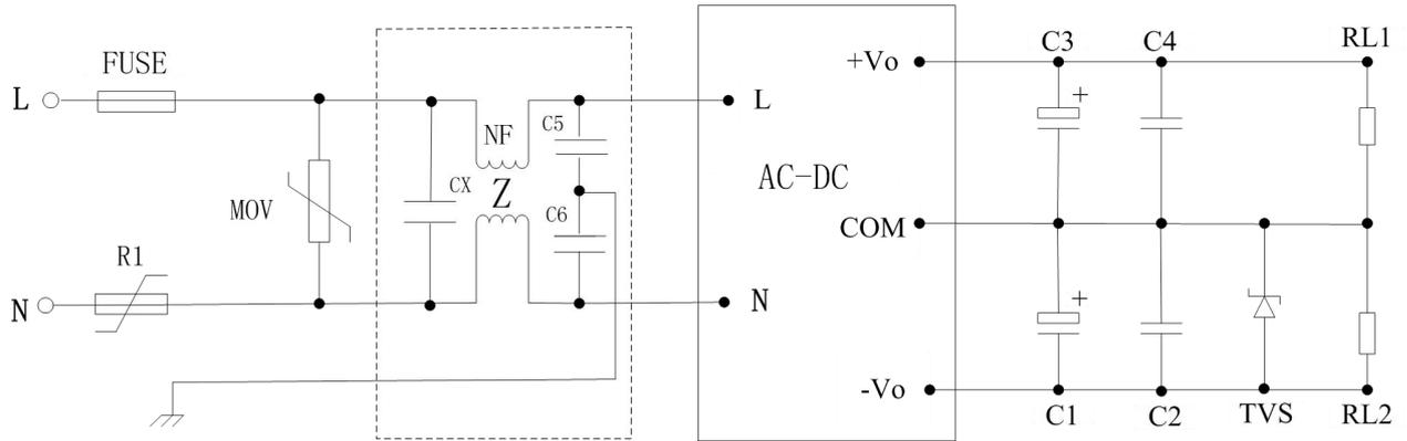
隔离双路输出EMC解决方案—推荐电路
