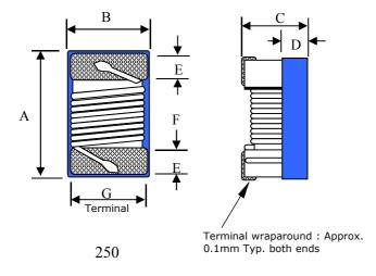
A max. : 2.90 mm B max. : 2.54 mm C max. : 2.03 mm D ref. : 1.30 mm E :  $0.5 \pm 0.1$  mm F :  $1.52 \pm 0.1$  mm G : 2.0 mm
