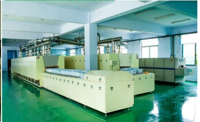
工厂车间图：排胶烧结车间
