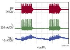
$3.3V_{\mbox{\footnotesize{IN}}}$  to  $1.2V_{\mbox{\footnotesize{OUT}}},$  2MHz TYPICAL APPLICATION  $I_{\mbox{\footnotesize{LOAD}}}=10\mbox{\footnotesize{mA}}$
