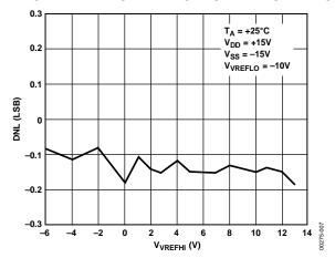
Figure 6. DNL vs. V<sub>VREFHI</sub> (±15 V)
