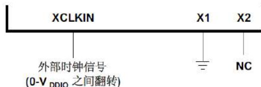
图8-1 XCLKIN接3.3V晶振时钟
