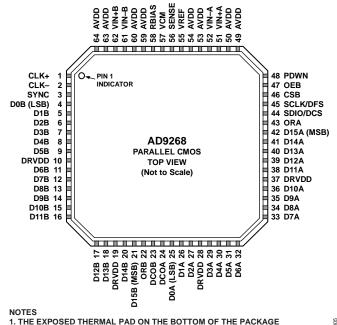
PROVIDES THE ANALOG GROUND FOR THE PART. THIS EXPOSED PAD MUST BE CONNECTED TO GROUND FOR PROPER OPERATION.
