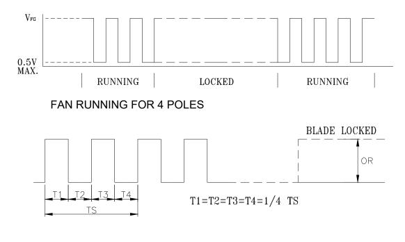
N=R.P.M TS=60/N(SEC) \*VOLTAGE LEVEL AFTER BLADE LOCKED \*4 POLES
