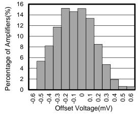
Figure 22. Offset Voltage Production
