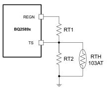
图 9-6. TS Resistor Network
