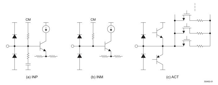
Figure 77. Equivalent Circuits of LNA inputs
