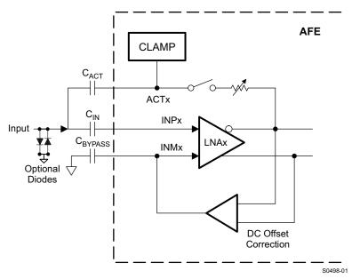
Figure 83. LNA Input Configurations
