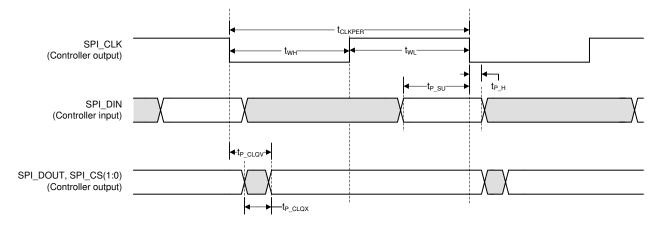
图 6-9. Flash Interface Timing
