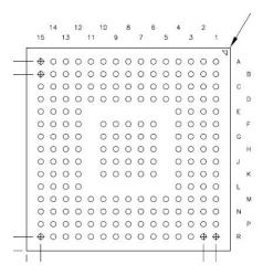
图 5-1. ZEZ Package 201-Pin NFBGA Bottom View
