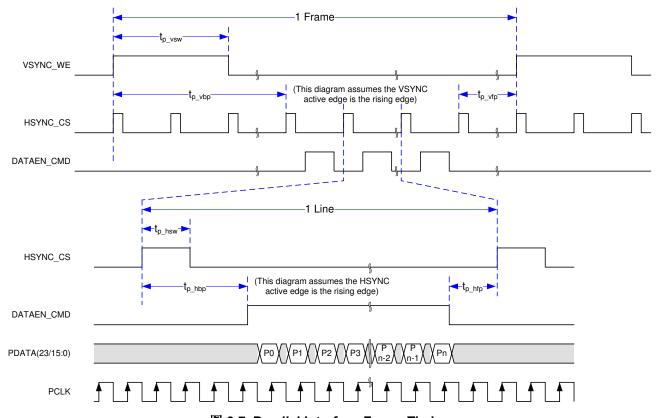
图 6-7. Parallel Interface Frame Timing
