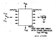
Fig. 13 - Input-voltage test circuit.
