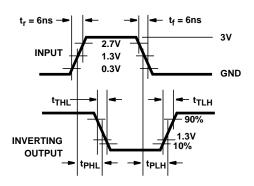
FIGURE 10. HCT TRANSITION TIMES AND PROPAGATION DELAY TIMES, COMBINATION LOGIC
