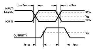
FIGURE 2. PROPAGATION DELAY TIMES
