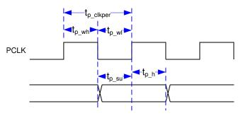
图 6-8. Parallel Interface Pixel Timing
