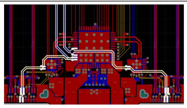
图 11-17. Complete USB2 Routing
