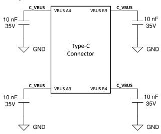
图 9-3. Type-C Connector VBUS Capacitors
