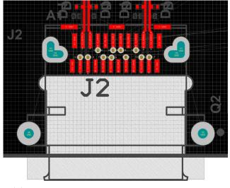
图 11-7. Type-C Connector SSTXRX Top Layer
