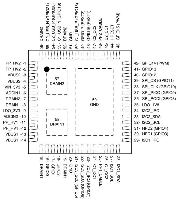
图 5-1. RSH Package 56-Pin QFN Top View
