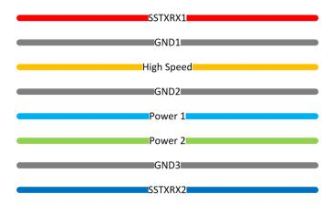
图 11-3. 8 Layer Board Stack Up
