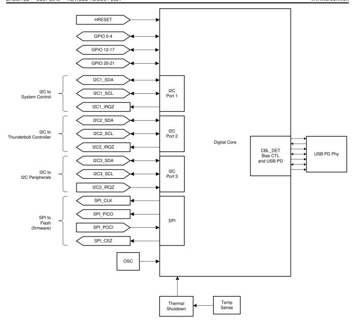
图 8-22. Digital Core Block Diagram
