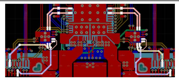
图 11-14. Complete CC Routing
