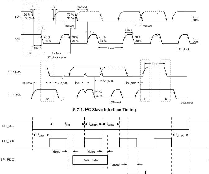
图 7-2. SPI Controller Timing
