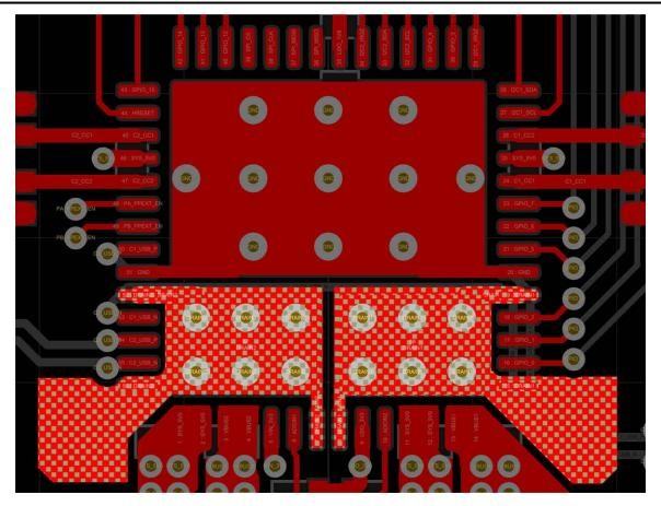
图 11-15. DRAIN1 and DRAIN2 Top Layer
