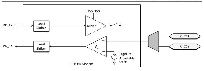
图 8-5. USB-PD BMC TX/Rx Block Diagram
