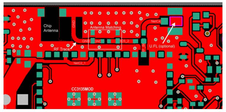
图 10-4. RF Section Layout
