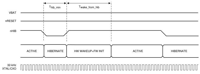
图 8-7. nHIB Timing Diagram
