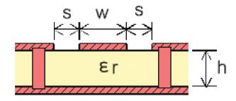
图 10-6. Coplanar Waveguide (Cross Section)
