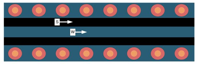
图 10-7. CPW With GND and Via Stitching (Top View)
