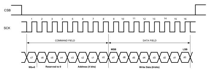
Figure 23. SPI Interface Protocol
