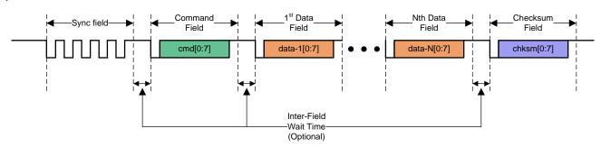
图 22. UART Interface Transmission Frame
