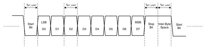
图 20. USART Asynchronous Interface Bit Timing
