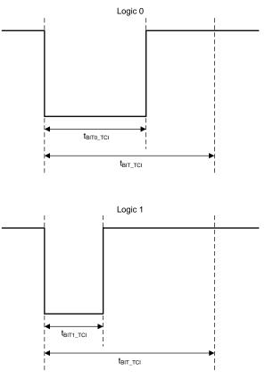
图 13. Time-Command Interface Bit Timing
