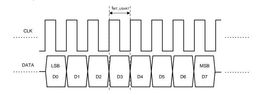
图 30. USART Synchronous Interface Bit Timing
