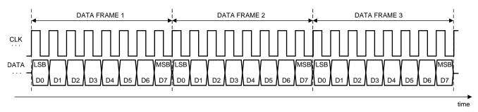
图 31. USART Synchronous Mode Data Flow
