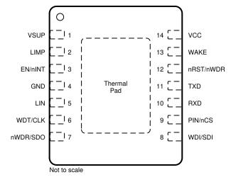
图 6-1. DMT Package, 14-Pin (VSON), Top View
