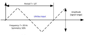
图 8-3. LIN Bus Input Signal
