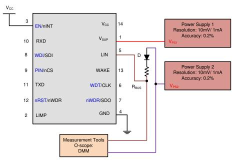
图 8-5.  $V_{SUP_NON_OP}$  Test Circuit
