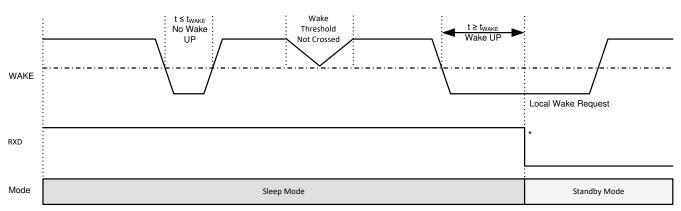
图 9-9. Local Wake Up (LWU) - Falling Edge
