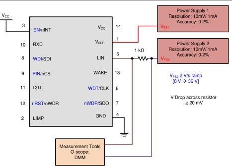
图 8-8. Test Circuit for I<sub>BUS\_PAS\_rec</sub>
