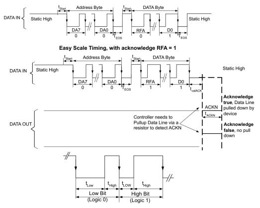
Figure 14. EasyScale<sup>™</sup>— Bit Coding
