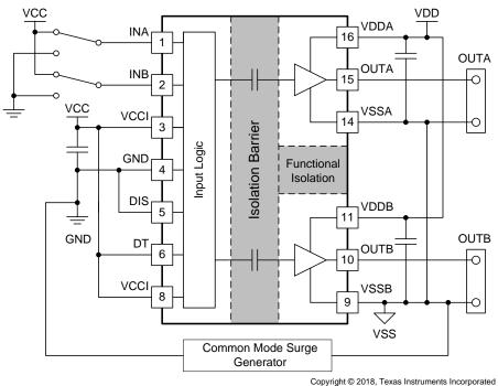
图 31. Simplified CMTI Testing Setup
