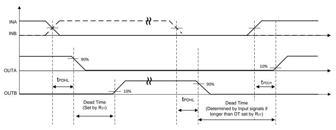
图 28. Dead Time Switching Parameters
