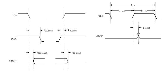
图 6-3. SPI-Compatible Serial Interface Timing
