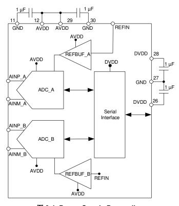
图 9-1. Power-Supply Decoupling
