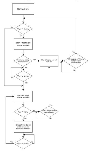
图 16. BQ21061 Charger Flow Diagram
