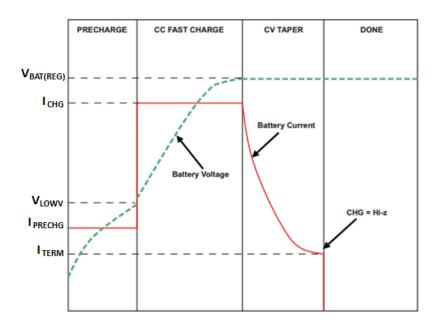
图 17. BQ21061 Typical Charge Cycle
