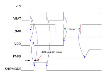
图 30. BQ21061 Wake-Up Upon Battery Insertion
