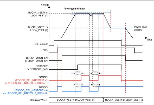
图 8-12. PGOOD Waveforms
