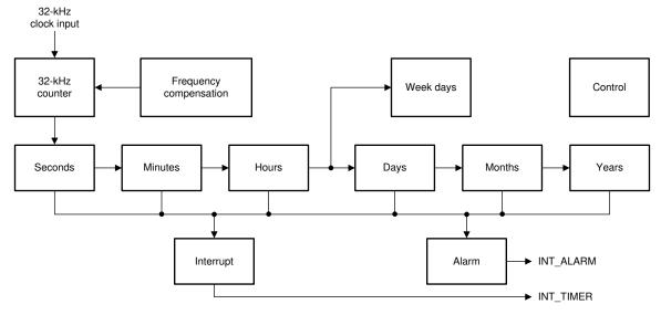
图 8-16. RTC Block Diagram
