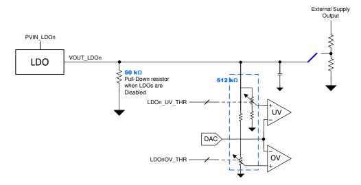
图 8-9. Impedance at the VOUT\_LDOn Pins
