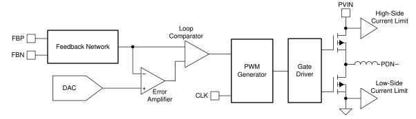
图 8-2. BUCK Core Block Diagram
