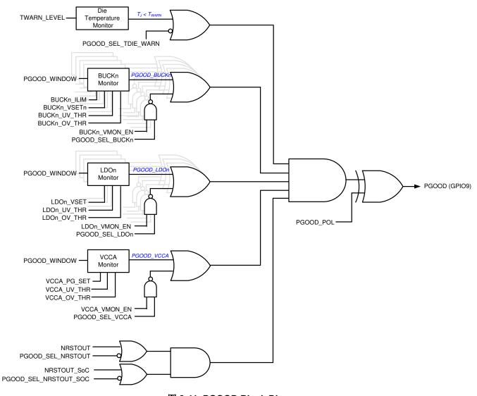
图 8-11. PGOOD Block Diagram
