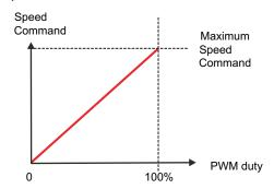
Figure 8-23. PWM-Mode Speed Command
