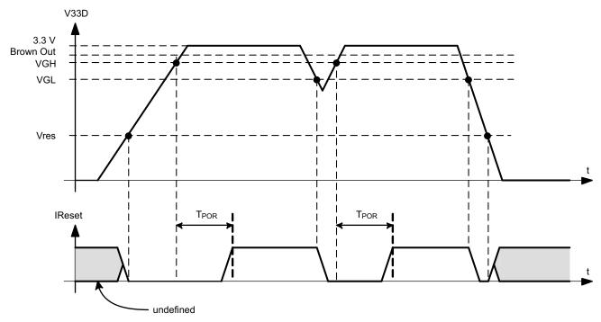
图 8-3. Power-On Reset (POR) and Brown-Out Reset (BOR)
