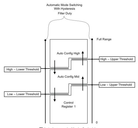
图 9-4. Automatic Mode Switching
