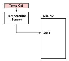
图 9-15. Internal Temp Sensor
