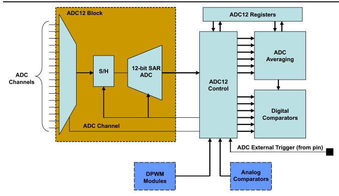
图 9-14. ADC12 Control Block Diagram
