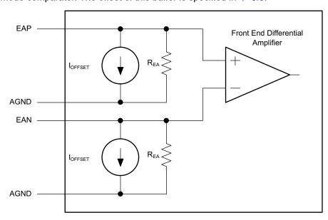
图 8-4. Input Stage of EADC Module
