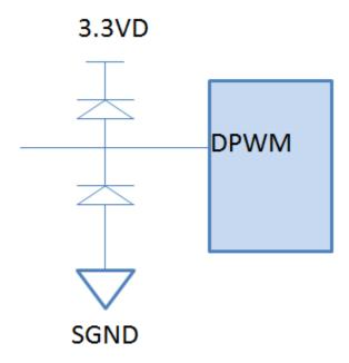
图 12-4. Clamping Diodes for DPWM
