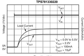
**INPUT VOLTAGE vs DELAY TO OUTPUT**
