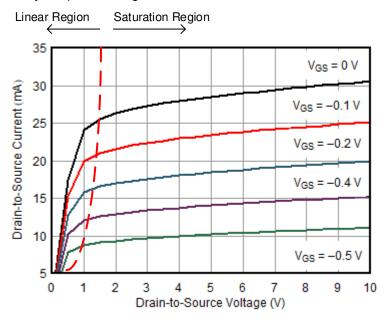
图 8-1. V<sub>DS</sub> vs I<sub>DS</sub>
