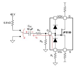
图 9-1. JFE150 Clamping Diode Example
