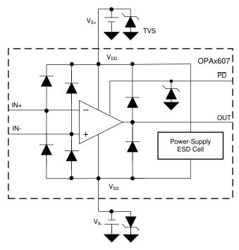
图 8-4. Internal ESD Structure
