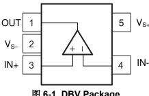
图 6-1. DBV Package 5-Pin SOT-23 Top View
