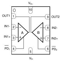
图 6-4. OPA2607 RUG Package 10-Pin X2QFN Top View
