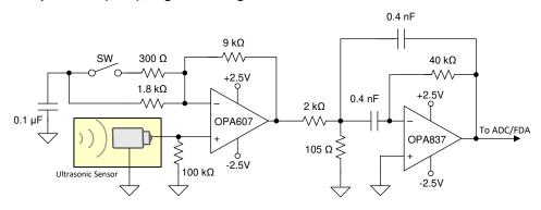
图 9-9. Hi-Z, High-Gain Front-End Circuit
