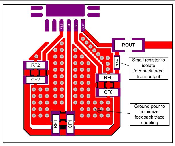
图 11-2. Feedback Network Layout Recommendations
