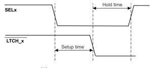
图 8-1. Timing Diagram
