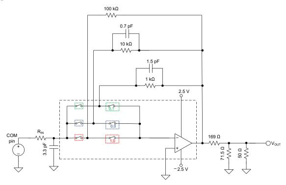
图 9-1. OPA3S2859-EP Test Circuit
