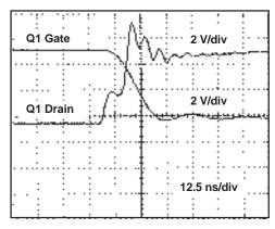
Figure 24. Q1 Turn-On Waveform
