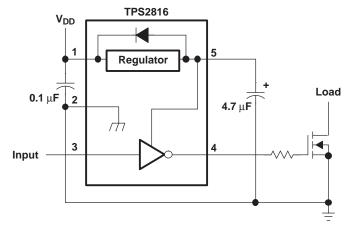
Figure 21.  $V_{CC} > 14 \text{ V}$
